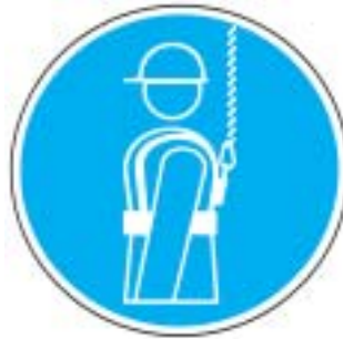
M09 Auffanggurt benutzen
